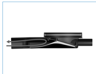
3 När vattnet tagit slut sluter låset tätt och stoppar avloppsgaser från att spridas i badrummet.
